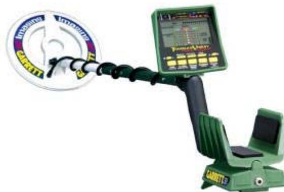
Тестировался Garrett GTI 2500, это самая последняя модель линейки GTI, предшественником его был GTI 2000. Изменения в 2500 модели были следующими, увеличена глубина поиска, добавлен сглаживающий фильтр на баланс грунта, более точное распознавание цели с помощью DSP процессора, система Fast Track. В общем и целом вид у 2000 и 2500 одинаков, различить их можно только по лейблу.
