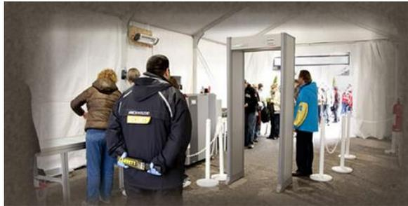
Простой и надежный арочный металлодетектор с микропроцессорным управлением. Используется для обнаружения любых металлических предметов запрещенных к проносу.
